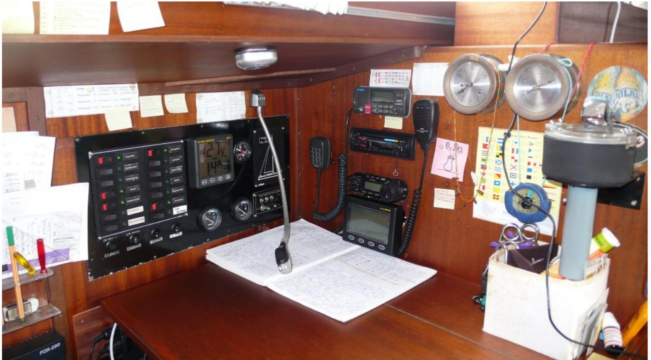
Panama 2013, Navigationsecke mit Blick auf Schalttafel, SSB Radio, AIS, Radio und UKW-Funkgerät
