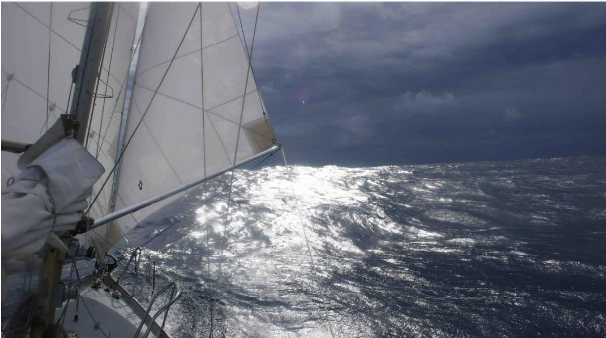
Meist hatte ich die Strumfock (8m<sup>2</sup>) und die Fock (18 m<sup>2</sup>) ausgebaumt. Die Stagreiter des zweiten Vorsegels hab ich einfach an das Fockfall angeschlagen, das an der stabilen Klampe auf dem Vordeck befestigt ist. Das Spi-Fall diente zum Hochziehen der Segel. Es ist nicht die beste Lösung, aber es hat funktioniert...
